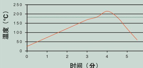
这个温度曲线适用于95.5Sn/3.8Ag/0.7Cu合金, 也为其他合金成分的回流曲线设定提供参考。同时用户也可根据实际的工艺要求进行调整。
